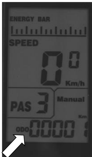
Anzeige der zurückgelegten Gesamtkilometer
