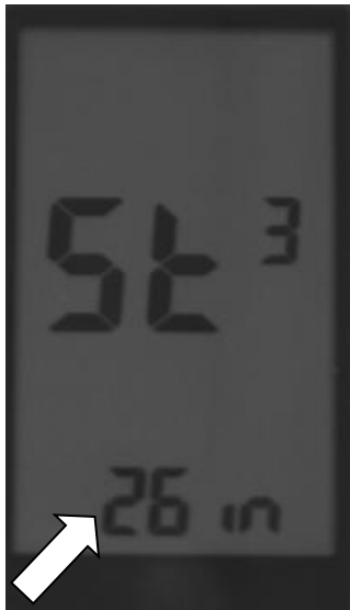
Einstellen des Reifendurchmessers
