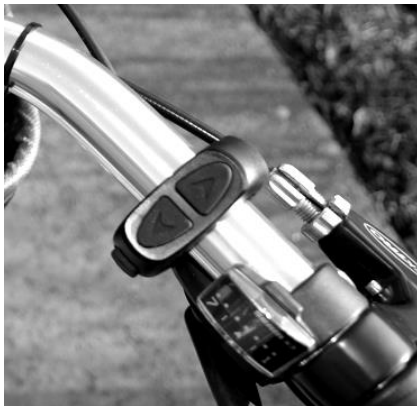
Bedienelement am Lenker montiert. Die Taste MODE muss zu Ihnen in Richtung Sattel zeigen
