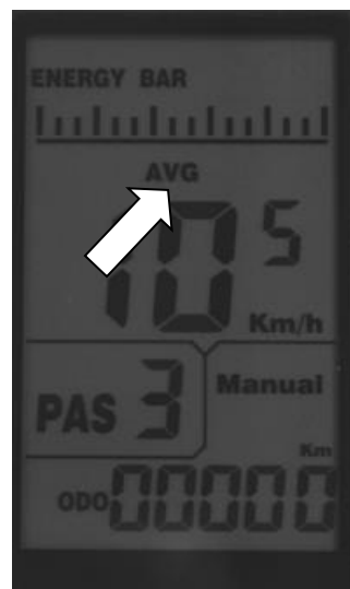
Anzeige der Durchschnittsgeschwindigkeit
