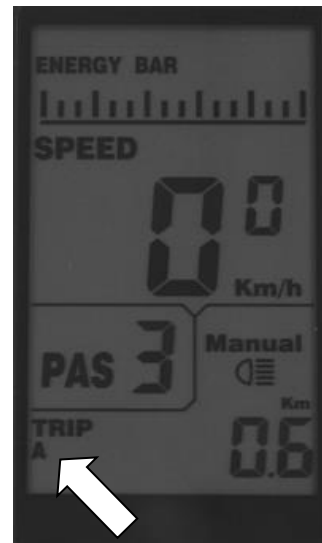
Anzeige Tageskilometerzähler A
