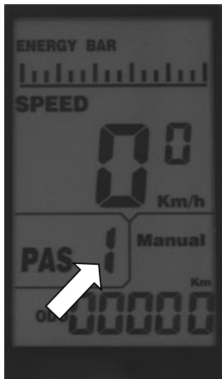
Anzeige der aktuell gewählten Unterstützungsstufe
