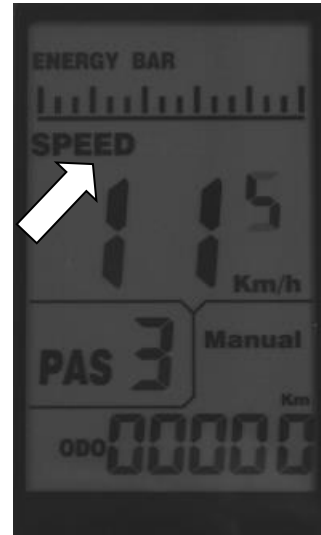
Anzeige der aktuellen Geschwindigkeit
