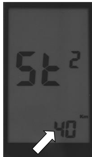
Einstellen der Höchstgeschwindigkeit mit Motorunterstützung
