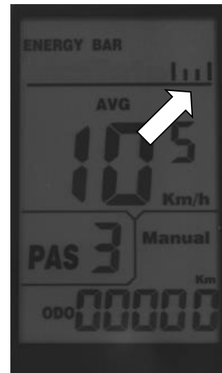
Nur noch ein Segment des Balkensymbols ist sichtbar, d.h. der Antriebsakku ist fast leer
