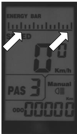
Alle Segmente des Balkensymbols sind sichtbar, d.h. der Antriebsakku ist vollgeladen
