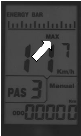
Anzeige der Maximalgeschwindigkeit
