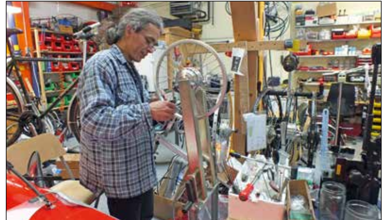
Das sogenannte Einspeichen des Motors ist die wichtigste Arbeit beim Umbau eines normalen Fahrrads zu einem eBike. Foto: Sandra Schwarz
